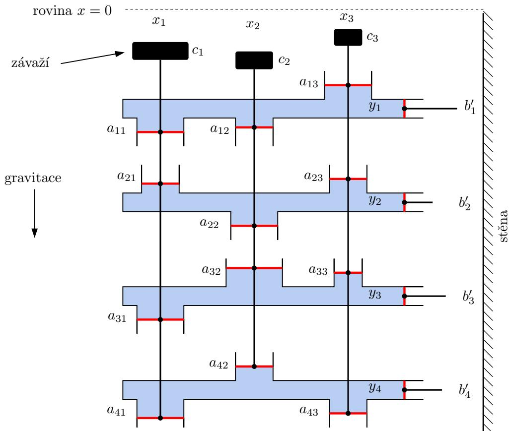
Obrázek 13.1: Hydraulický počítač řešící primární i duální úlohu LP.
