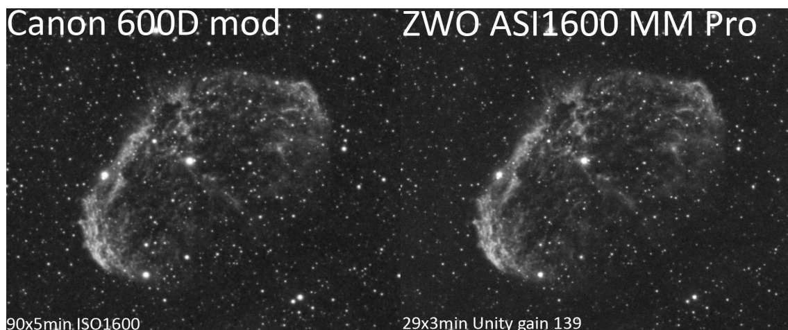
Srovnání použití H-alpha filtru modifikovanou zrcadlovkou a mono kamerou, pro zrcadlovku měl filtr šířku pásma 8nm, pro mono kameru 7nm. Oba snímky byly pořízeny stejnou technikou.
